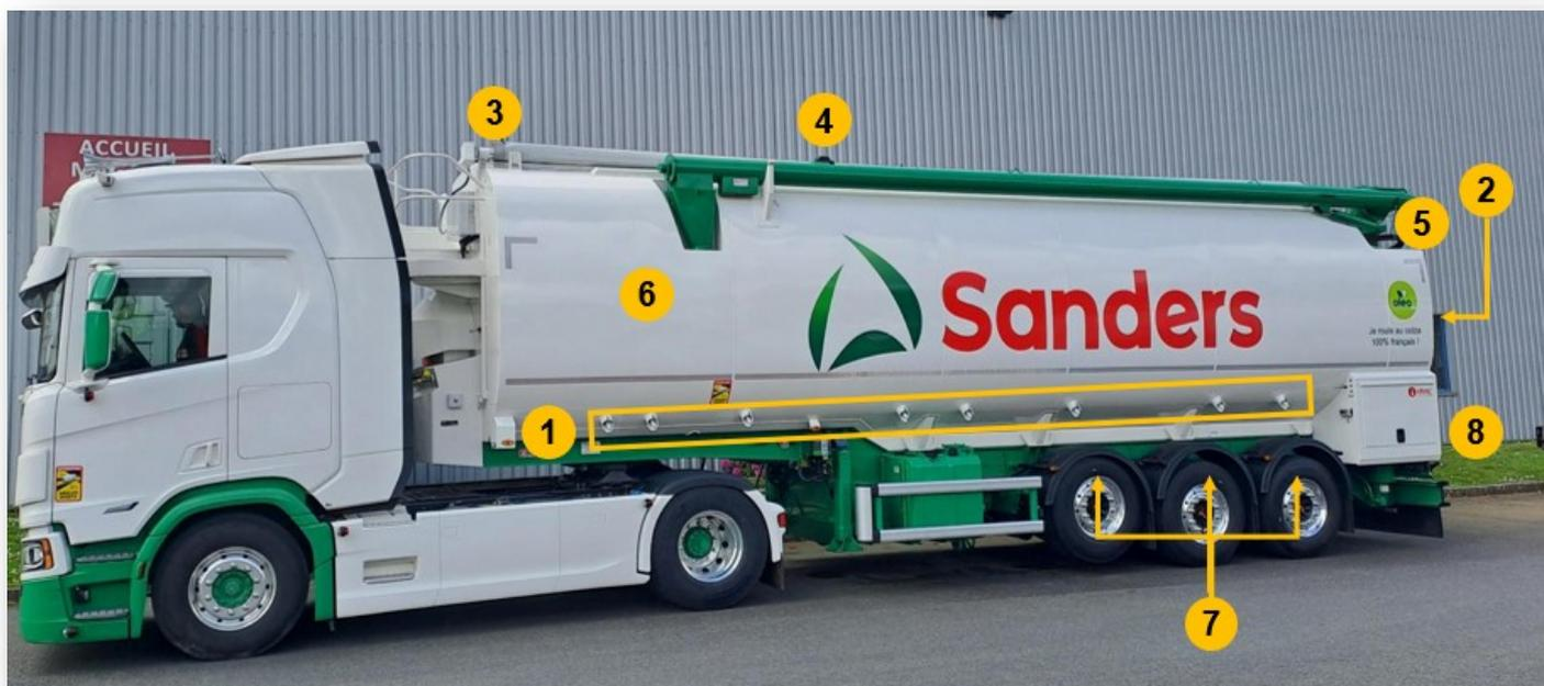
❶ buses latérales pour la prise d'échantillons au sol ❷ une seule échelle rétractable à l'arrière, ❸ bâchage et débâchage automatique, ❹ détecteur de lignes électriques sur la vis, ❺ radar de recul, caméra, freinage automatique si obstacle, ❻ marteau vibreur et caméra dans les compartiments, ❼ système de désinfection embarquée, ❽ trappe pour positionner un fumigène au sol
