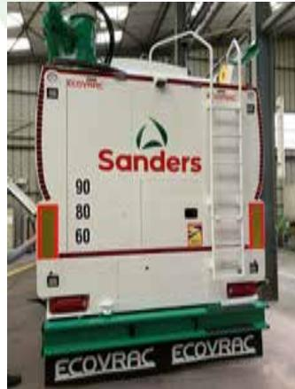
Une seule échelle rétractable à l'arrière
