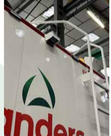
Radar de recul, caméra, freinage automatique si obstacle,
